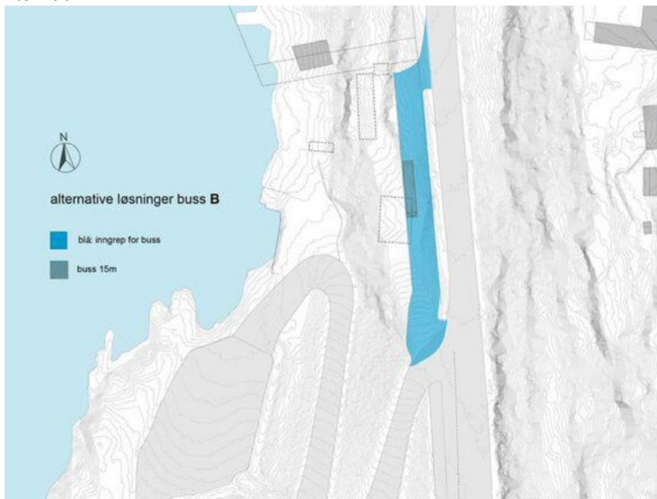
Figur 4 Illustrasjon som viser mulighetsstudiets anbefalte alternativ med oppstillingsplasser for buss langs fv. 155. Figur: Blakstad Haffner Arkitekter AS
